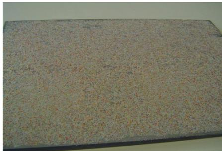
Figure 5.2: Echantillon d'un sol rugueux obtenu par collage de particules solides
