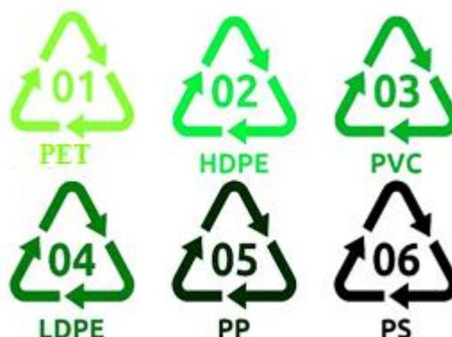
**Figure I.17 :** Codes d'identification des produits plastiques recyclables [27]
