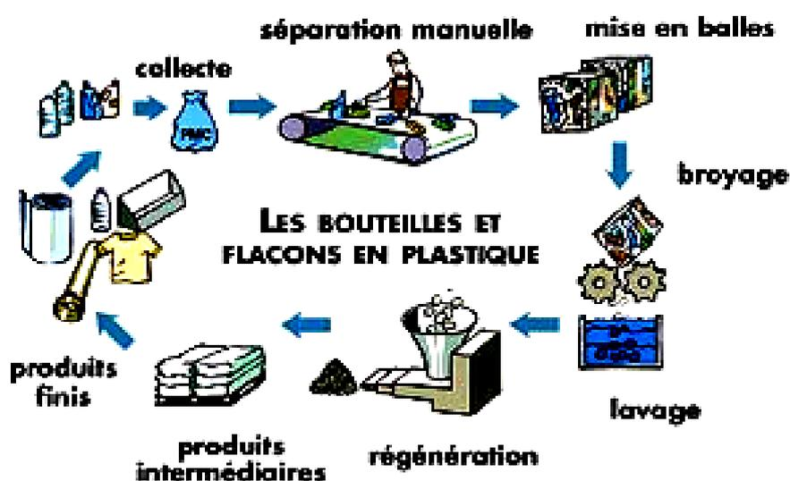
Figure I.19 : Etapes de recyclage des bouteilles en PET [36]
