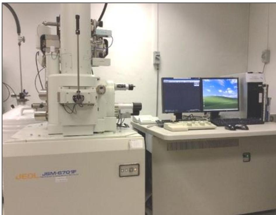
**Figure II.13:** Image de Micrographies au microscope électronique à balayage (FESEM, JEOL, JSM-6701F).
