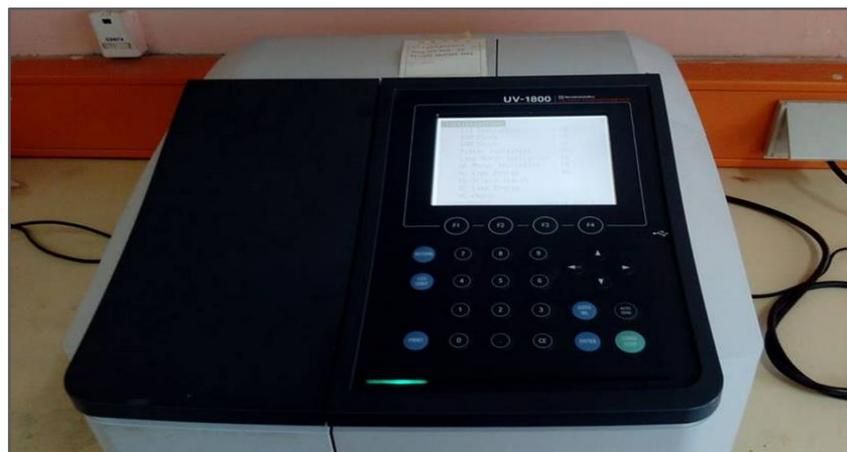
**Figure II.11** : spectrophotomètre double faisceau Shimadzu UV-1800.
