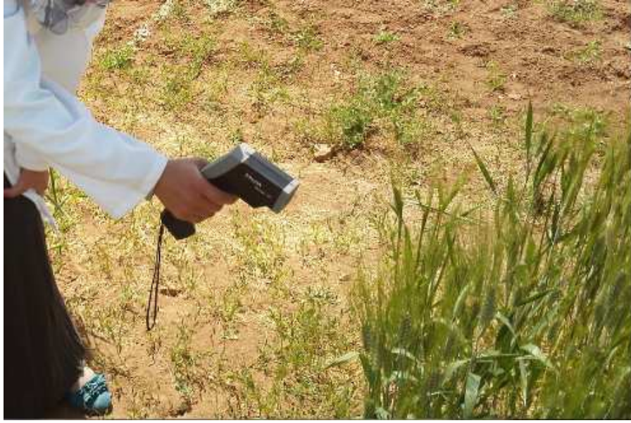
شكل II.7: جهاز قياس درجة حرارة الغطاء النباتي وطريقة العمل.
