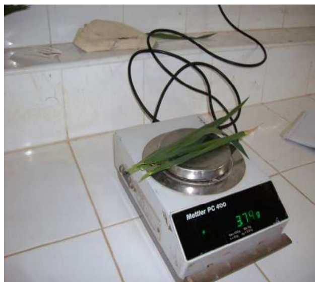
شكل II 4: عملية تحضير و وزن خمسة أوراق لقياس المحتوى المائي النسبي.
