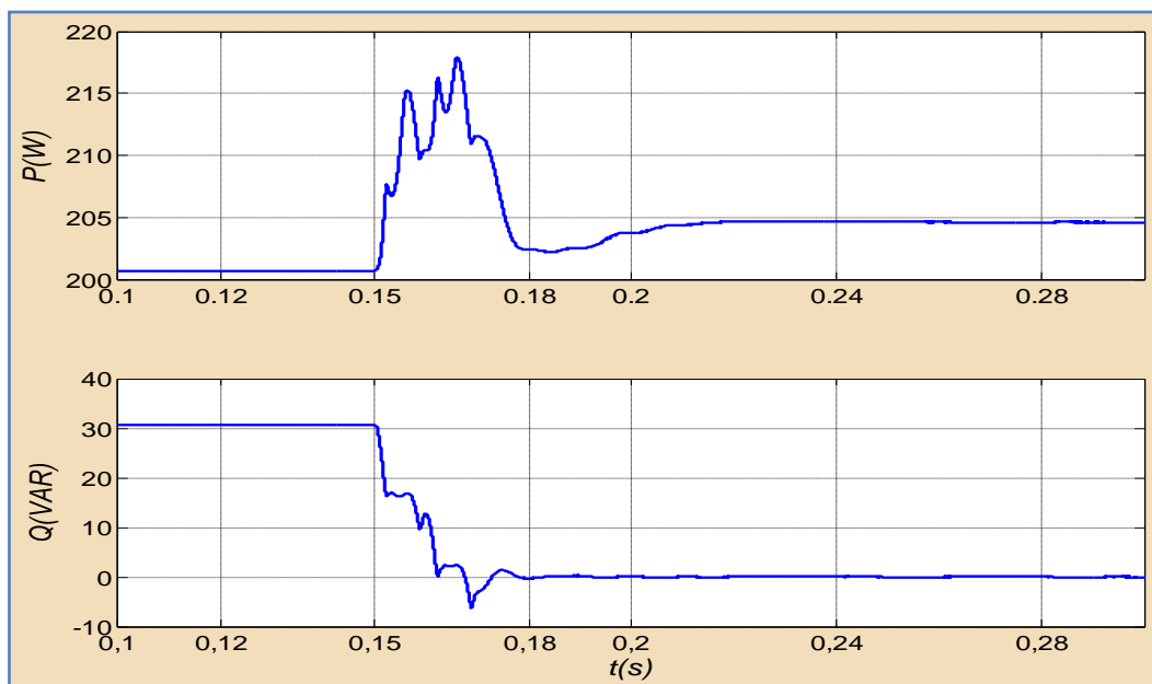
Fig. II.16. Allures des puissances instantanées de la source lors de la fermeture du FAP à l'instant t=0.15s .
