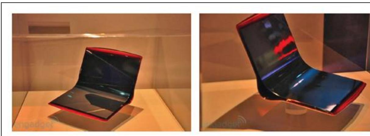
*Figure I.10 : Photo d'un PC portable basé sur le concept Sony OLED flexible*
