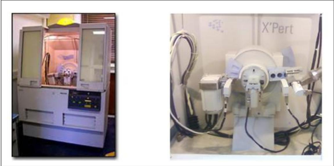
*Figure II. 14 : Diffractomètre X Pert PRO*
