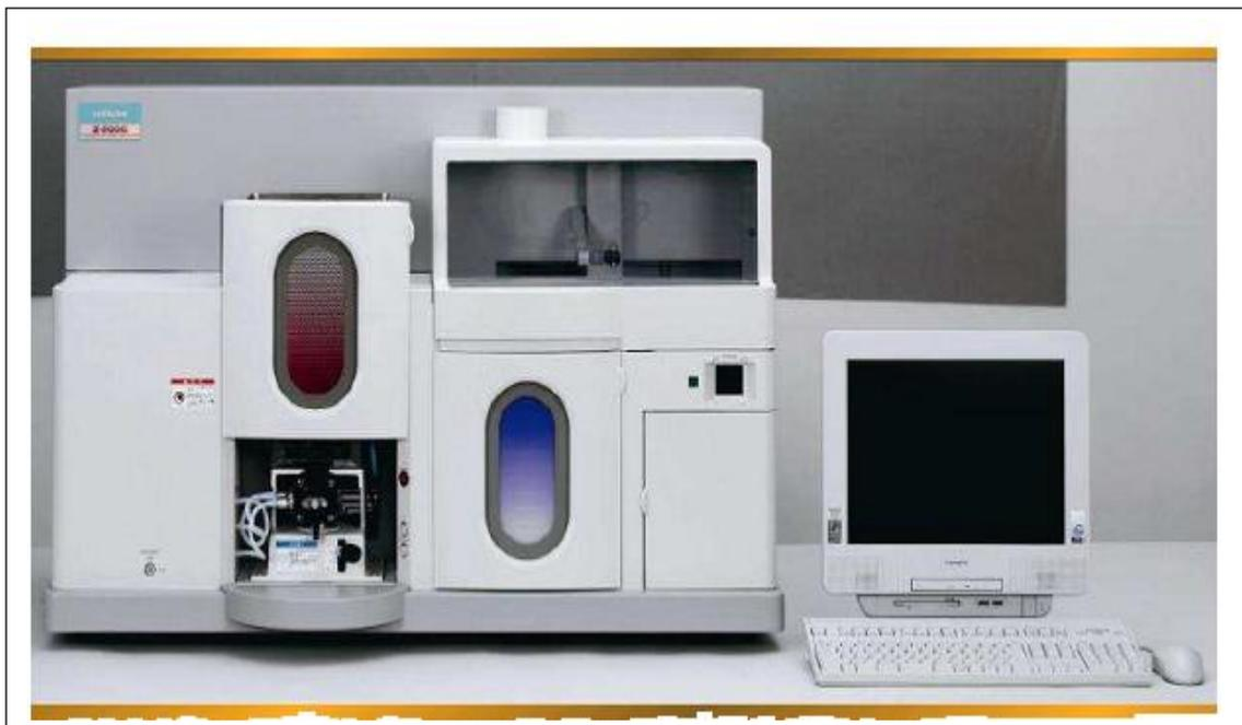
*Figure II.12 : Spectrophotomètre d'absorption atomique de type Hitachi Z-2000*
