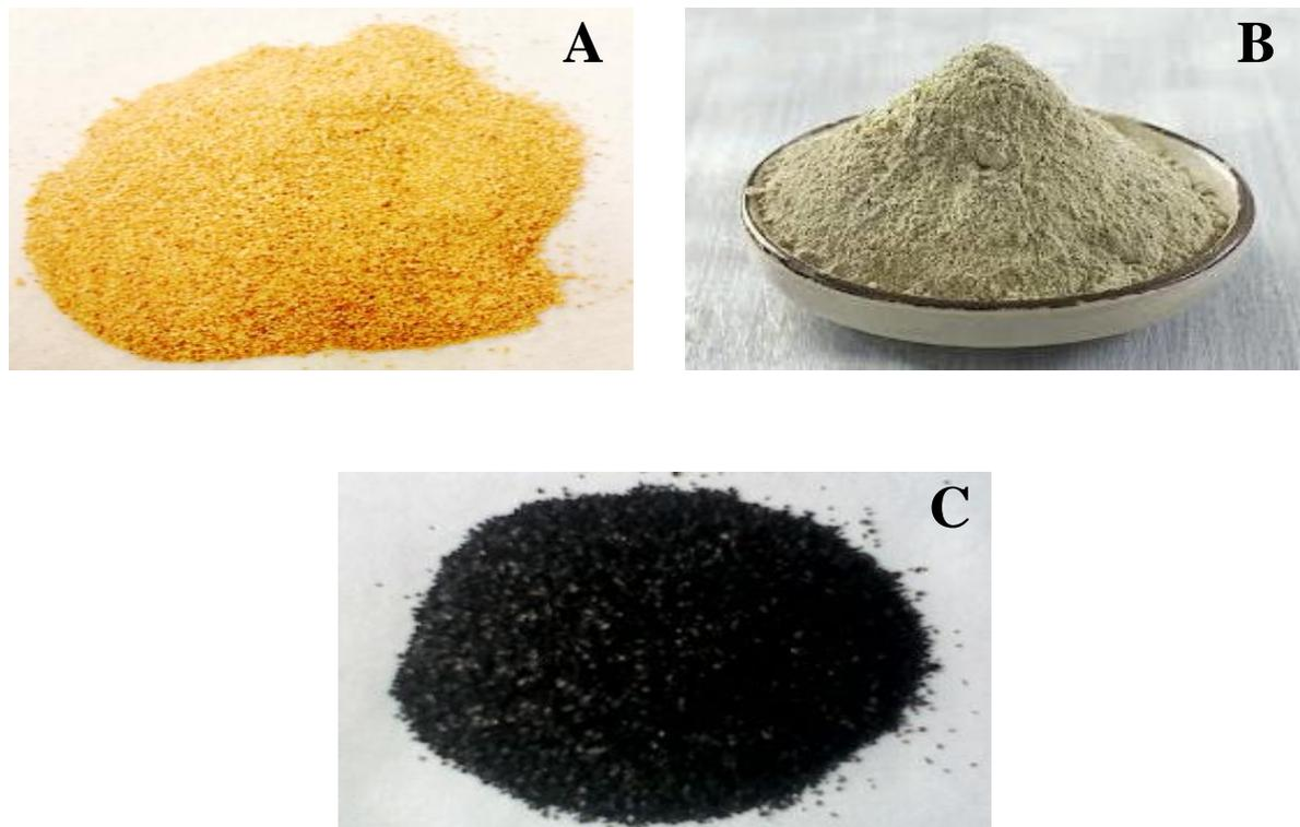
**Figure II.1.** (A) Pelures de citron, (B) Bentonite du gisement de Maghnia, (C) Charbon actif industriel type Darco 12-20 mesh.
