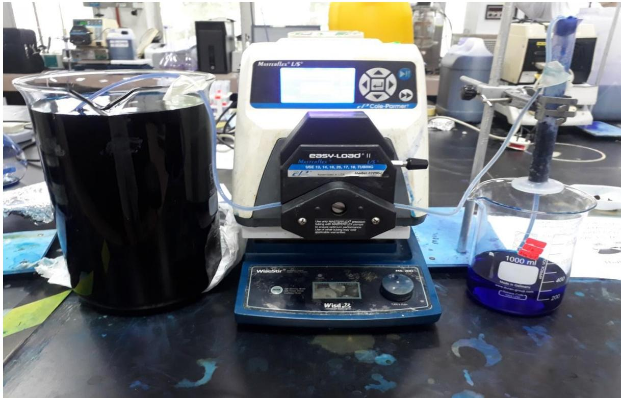
**Figure II.10.** Montage expérimental d'adsorption du BM en lit fixe.
