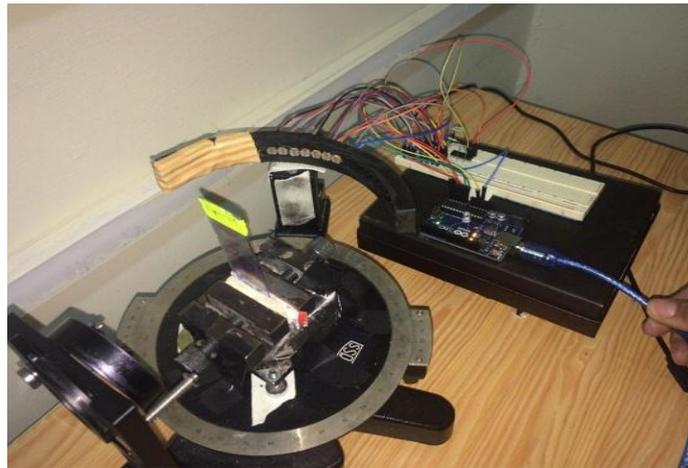
Figure 4.5 : Photo de détecteur optoélectronique hémisphérique
