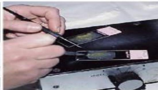
Figure 2.13 : **Etalement du ruban sur une lame en utilisant l'eau (40°C) pour éviter la création des bulles d'air.**
