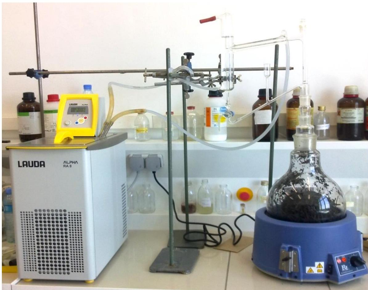
Figure 19: Dispositif d'extraction des huiles essentielles, type Clevenger
