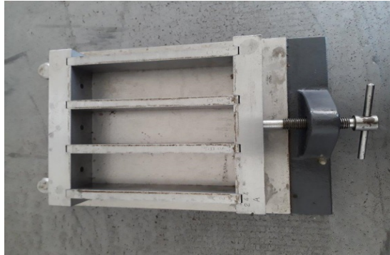
Figure II.8: Moule d'échantillon de béton.
