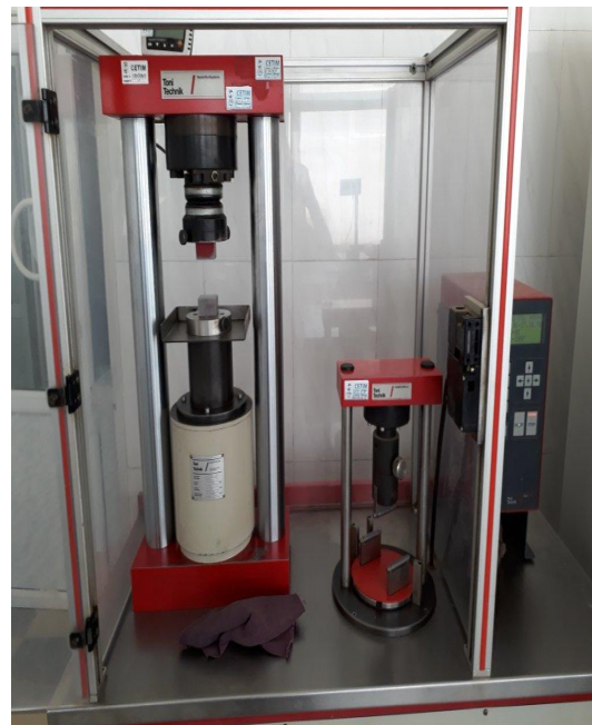
Figure II.10: Appareil de mesure de la contrainte mécanique.
