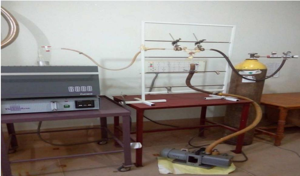
**Figure 2** : Montage expérimentale du traitement thermique.
