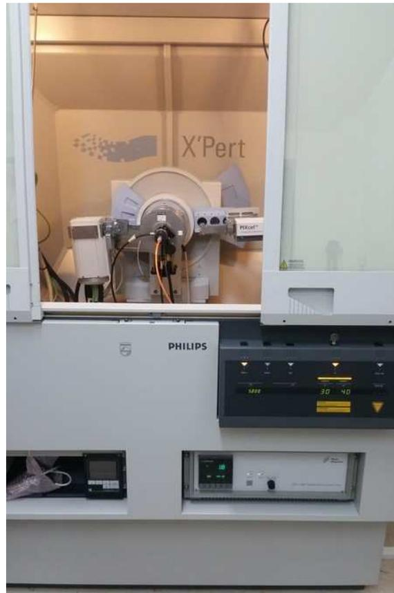
**Figure 4 :** Diffractomètre X'Pert Pro.
