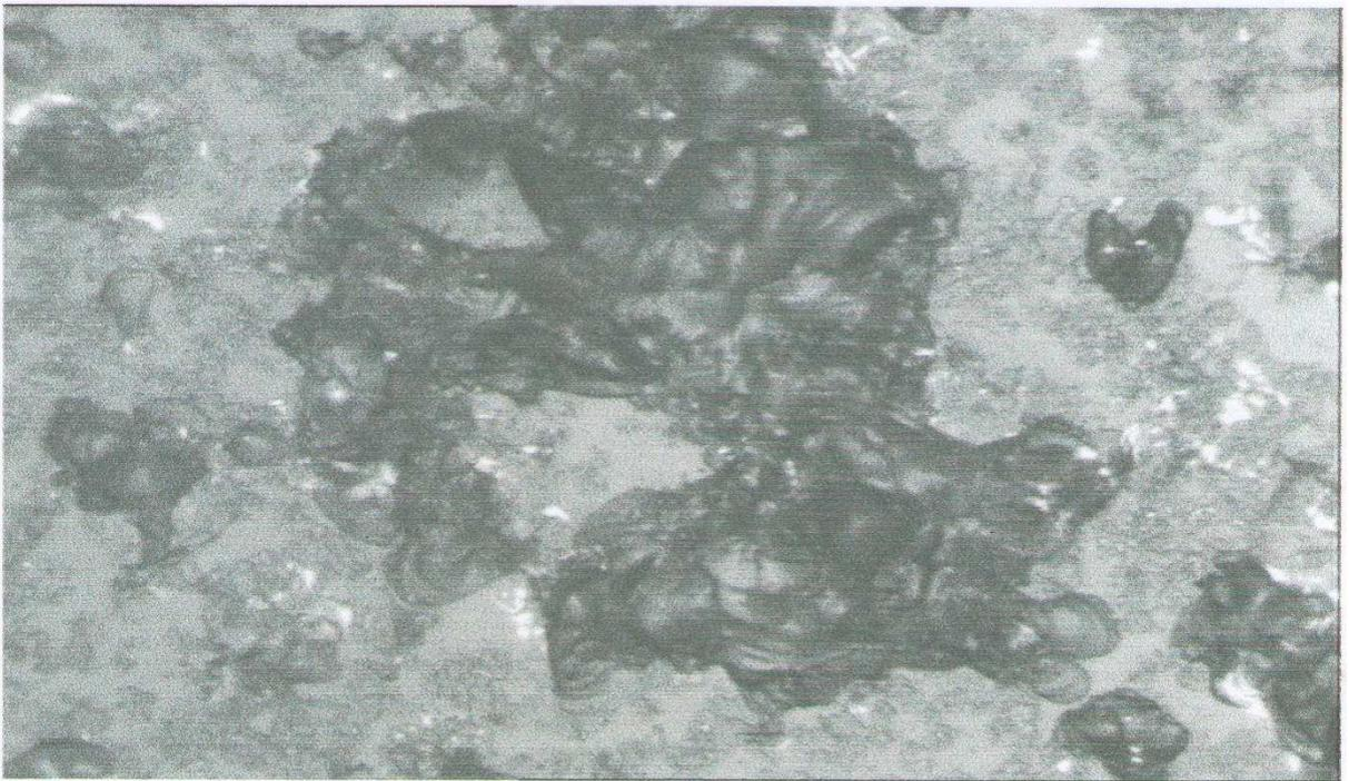
Fig. 3.36 : Micrographies de verre sodocalcique sablé pour ( $m=100g$  et  $\alpha=90^\circ$ ) (x 50).
