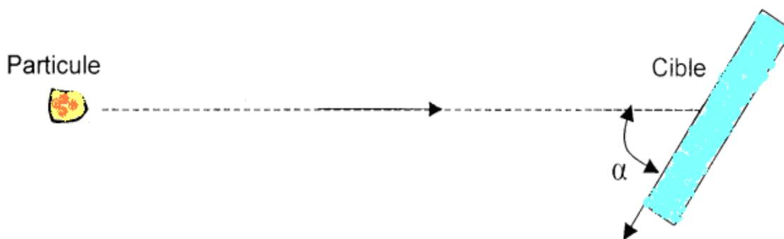
Figure 1.7 : Schéma illustrant le principe d'essai d'érosion par des particules solides projetées sur une cible fixe incliné.
