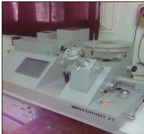
Figure 3.8 : Microscope métallographique.
