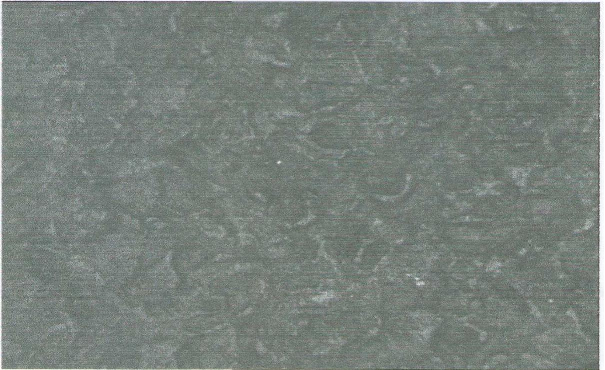
Fig. 3.44 : Micrographie du polystyrène sablé pour ( $m=100g$  et  $\alpha=90^\circ$ ) (x 50).
