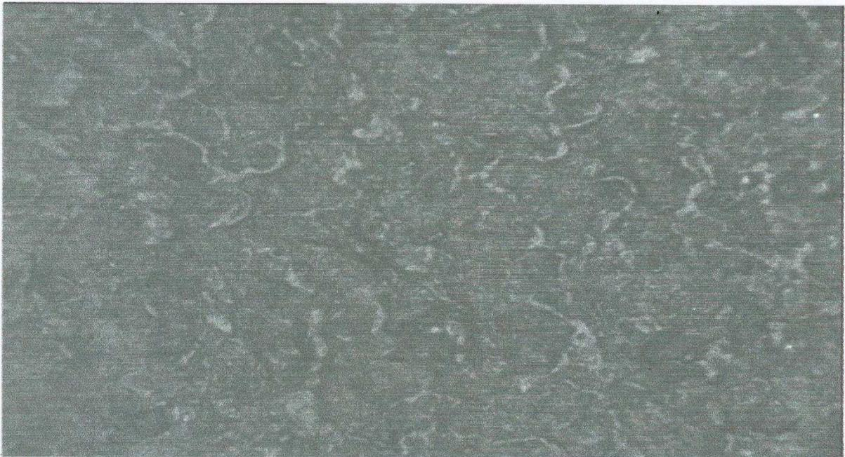
Fig. 3.41 : Micrographies du polystyrène sablé pour ( $m=100g$  et  $\alpha=30^\circ$ ) (x 50).
