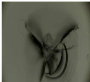
Figure 1.5 : Micrographie montrant un défaut de surface typique de sablage(x96) [10].
