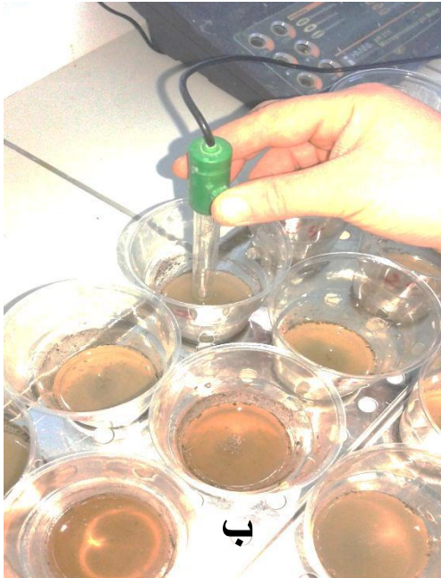
ب: قياس الحموضة بواسطة pH mètre
