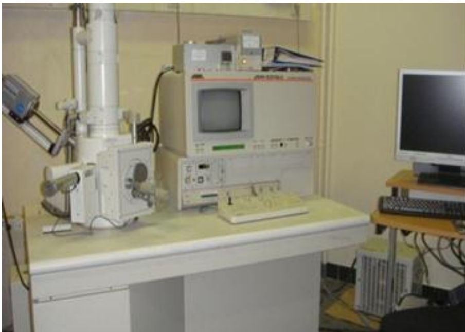
Figure 4.1 : Appareillage utilisé pour les mesures EDS.
