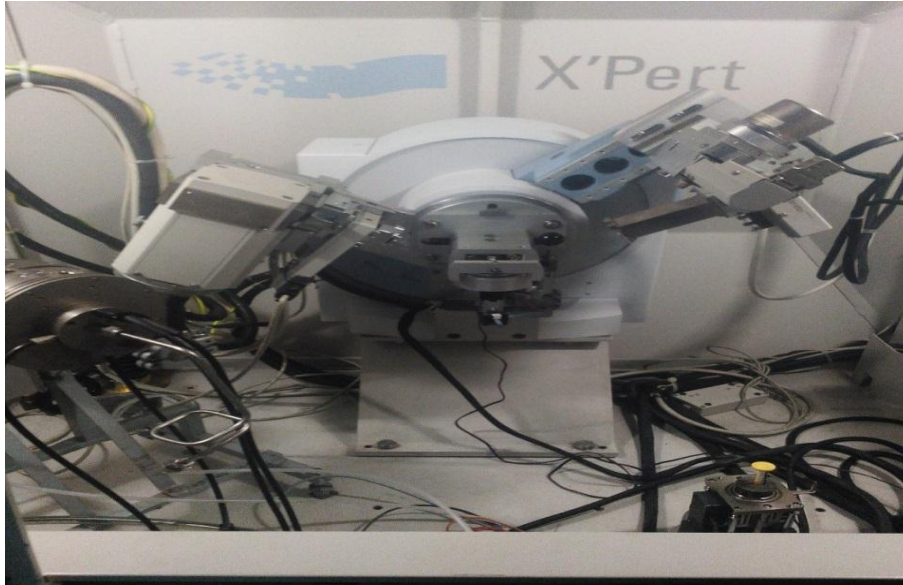
Figure 4.3 : Diffractomètre utilisé pour l'analyse structurale de nos échantillons.
