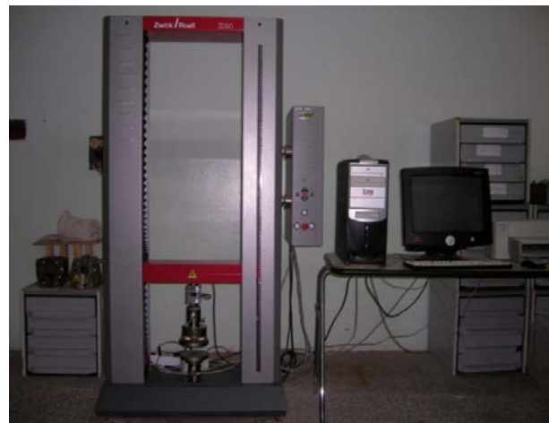
Dispositif de mesure de la résistance mécanique IOMP (Setif)
