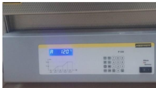
Figure IV-4. Recuit dans un four à 120°C.
