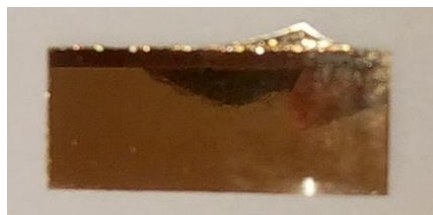
Figure IV-8. Couche d'or déposé sur la lame témoin de référence (énoncé dans la fig. IV-5).
