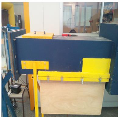
FIGURE 2.8 – Piège de sable : Ce caisson sert à collecter le sable transporté par le vent. Après la collecte du sable il sera pesé.
