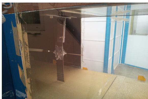
FIGURE 2.10 – Un tube pitot installé à une distance de 6 m de l'entrée de la soufflerie et à 13 cm du lit de sable de façon à mesurer la vitesse du vent  $U_\infty$  en dehors de la couche limite.
