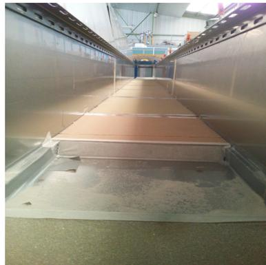
FIGURE 2.12 – Illustration de la transition entre un lit érodable et un lit rigide. Sur cette figure la longueur du lit érodable est de 20  $cm$  et le reste est couvert par des plaques rigides constituant le lit rigide.
