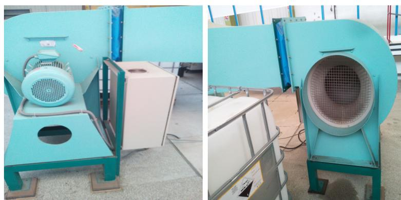
FIGURE 2.4 – La partie moteur : Face avant et arrière.
