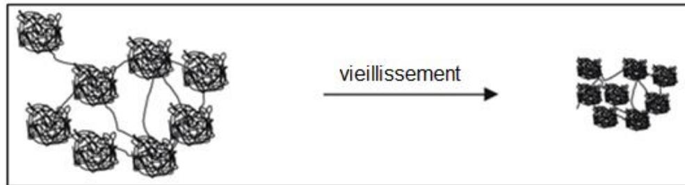
**Figure 3.2** : Gels obtenus à partir de tétralcoxydes de silicium par catalyse basique [27].
