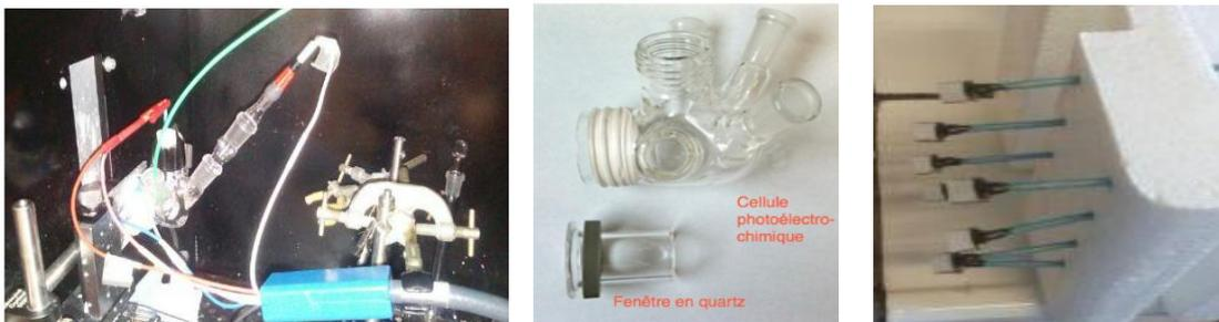
**Fig. IV. 13 :** Cellule photoélectrochimique (à gauche et au milieu) et des photoélectrodes (à droite).
