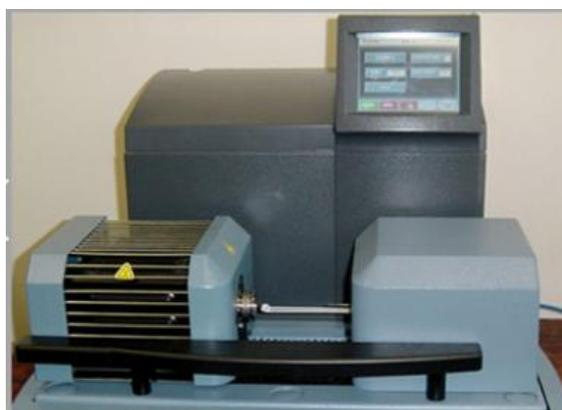
**Fig II. 1:** Appareil d'analyse thermique SDT-Q600 (TA INSTRUMENTS).
