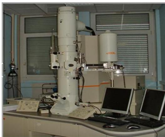
**Fig II. 2:** Microscope électronique à transmission JEOL JEM-2001.
