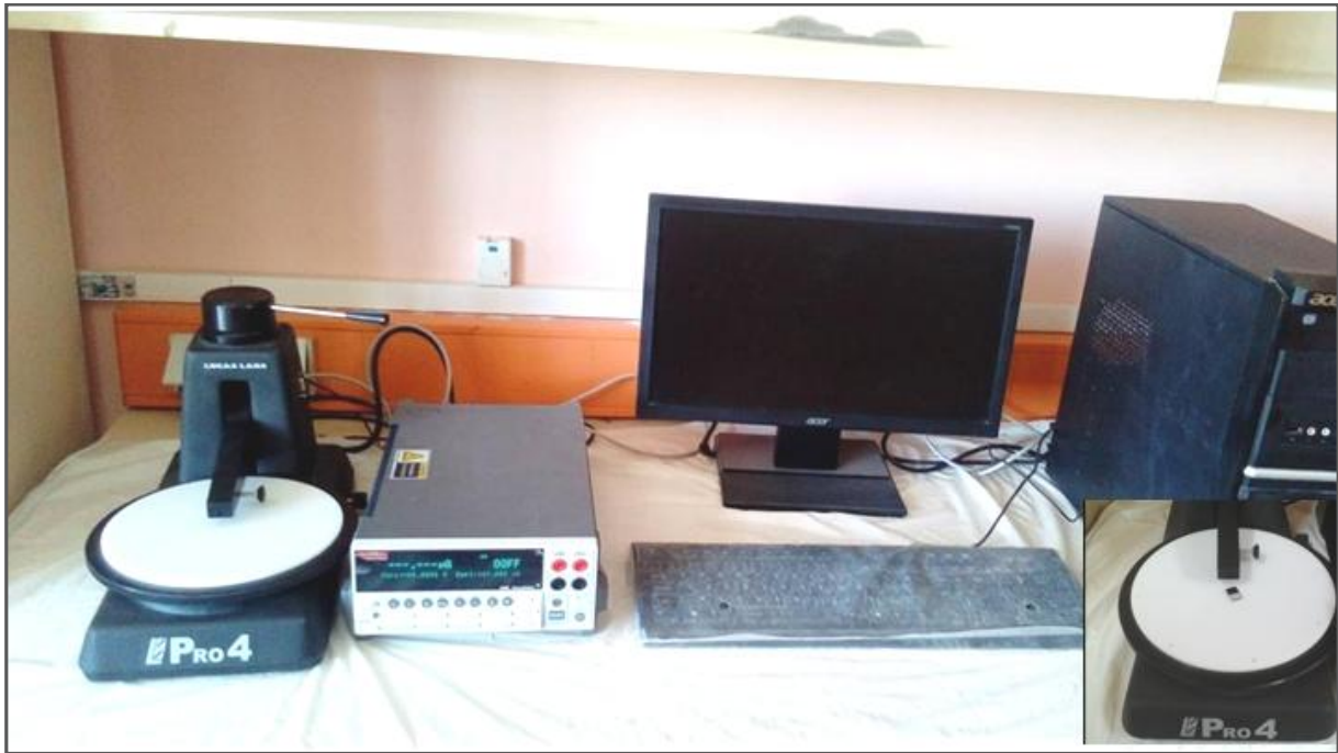
Figure II.15 : Montage expérimental utilisé pour la mesure de la résistivité par la méthode des quatre points.
