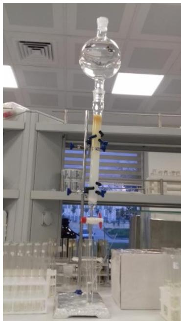
**Figure 12 :** Colonne chromatographie avec gel de silice
