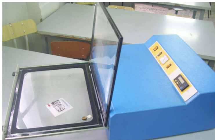
Figure V.2: Insoleuse UV des circuits imprimés.
