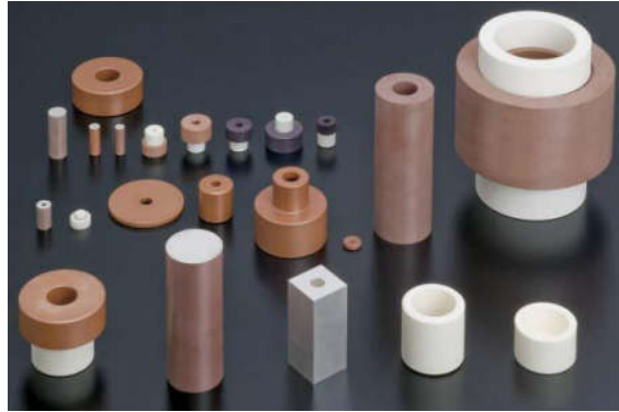
Figure II.24: Résonateur diélectriques de différentes formes. [32]
