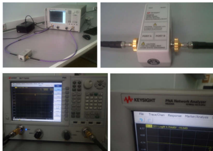
Figure V.7: Calibrage de l'analyseur N5224A par le module N4691B.
