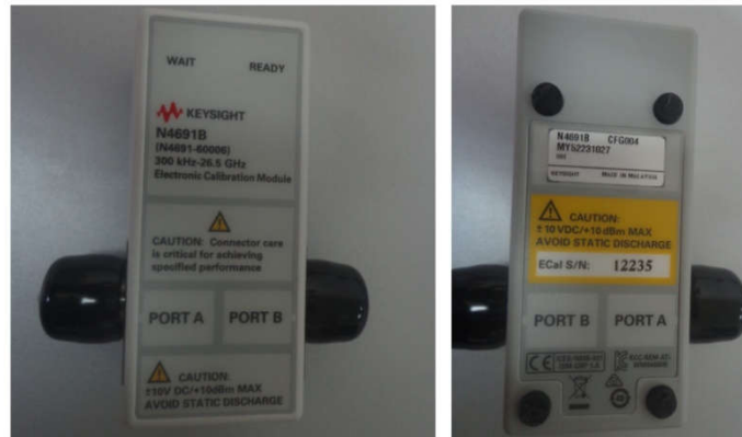
Figure V.6: Module de calibration électronique N4691B.
