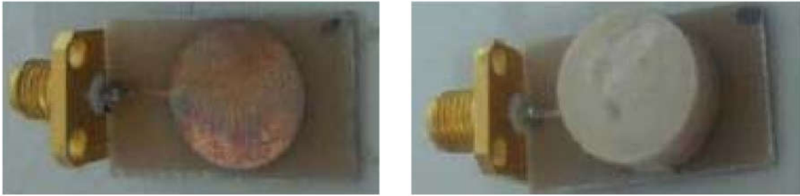
Figure III.20: Prototypage de l'antenne microruban réalisée sans et avec CDR.
