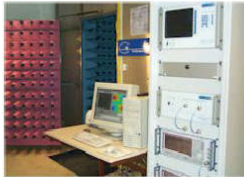
Figure IV- 1: la chambre anéchoïde et les instrument de mesure.
