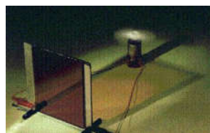
Figure I-3 : Vitres électrogènes actionnant un ventilateur [23].
