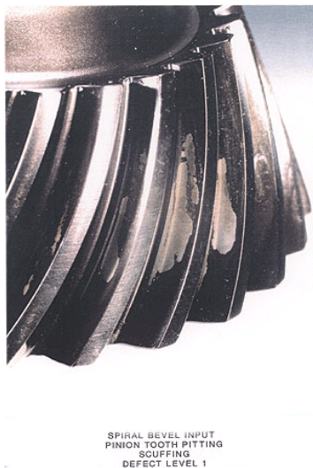
Figure 2. Généralisation de l'écaillage.
