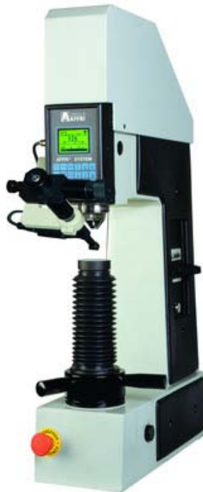
Fig. 4. 2 : Microduremètre semi automatique du type AFFRI à pénétration Vickers
