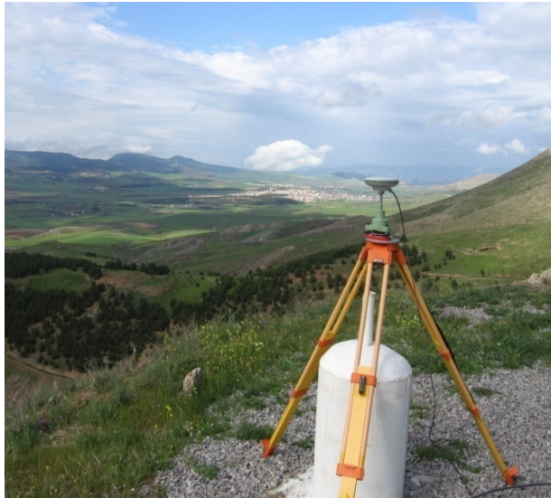
Photos IV.3 : L'accès du point (609) étant difficile, un autre point voisin a été choisi (support de drapeaux (609b))
