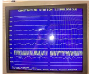
Photo V.2 : Numérisation du signal analogique de la station de Constantine
