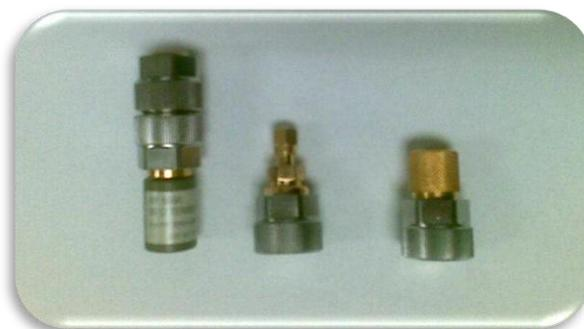
**Figure 3-13:** Les charges terminales :  $50\Omega$ , court-circuit et  $75\Omega$ .
