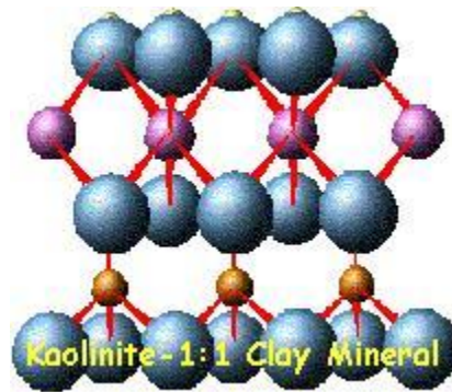
Figure I.1 : Structure d'un minéral (1/1) exemple de la kaolinite
