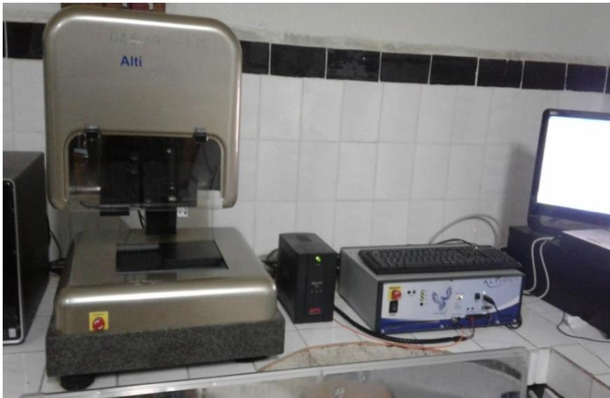
Figure 3.6 : Plateforme de métrologie de surface : AltiSurf 500.
