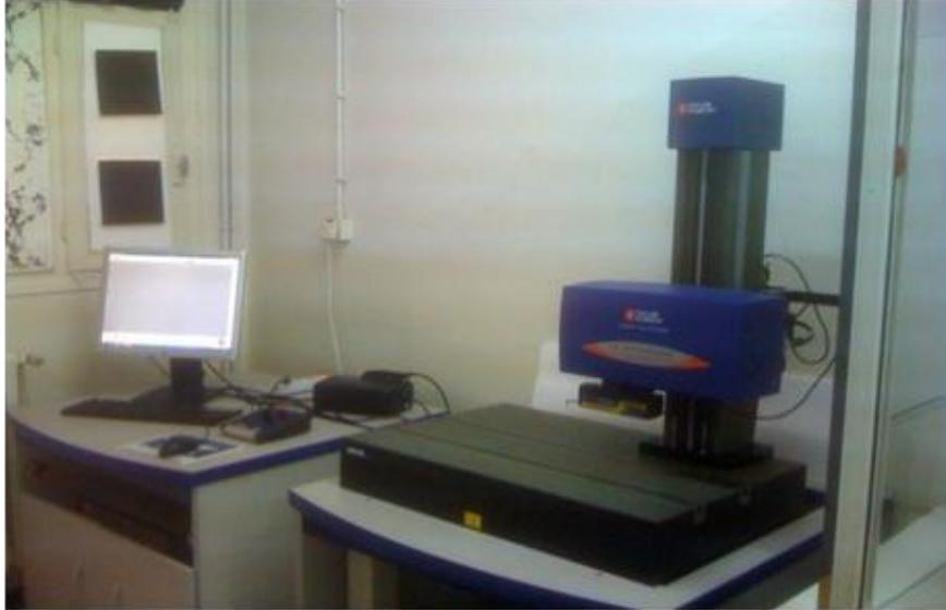
Figure 3.5 : Profilomètre de type 2D Taylor Hobson 120.
