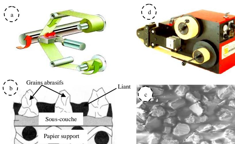
Figure 1.2 : Principe de toilage par galet (a); Structure de la bande (b); Vue au MEB d'une toile réelle de calibre 20  $\mu\text{m}$  (c); Exemple du dispositif de toilage par galet (d) [Jou05, Khe07a].
