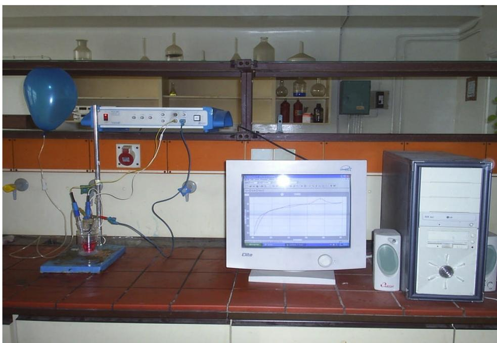
*Figure II.1: Dispositif expérimental de la chaîne électrochimique.*
