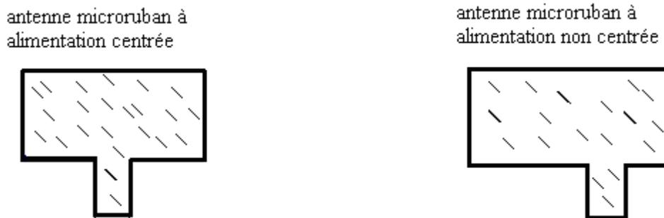
**Figure 1.18. Différentes alimentations centrées et non centrées pour la forme rectangulaire.**
