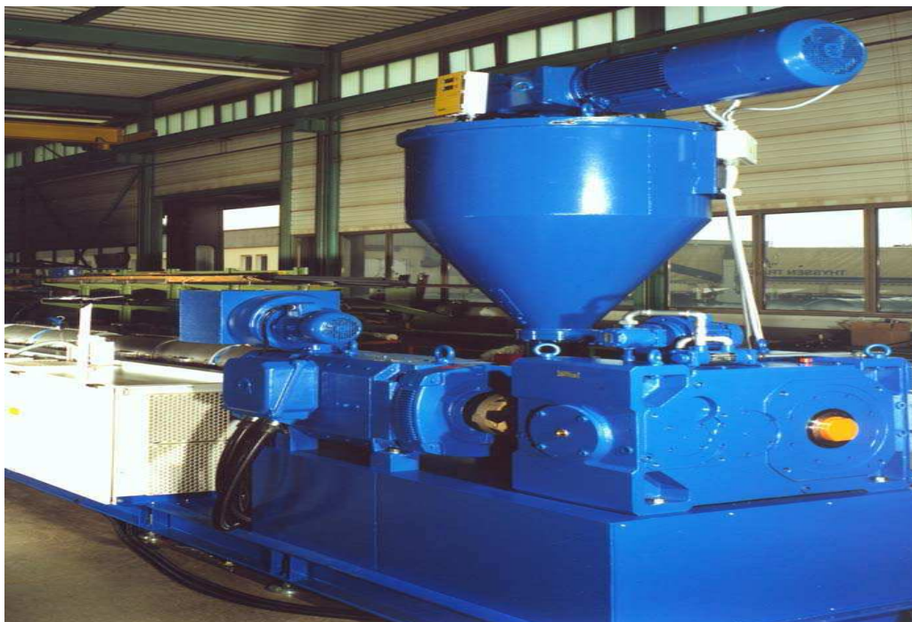
Figure 7.1 : Vue d'ensemble de l'extrudeuse - machine de fabrication de tuyauterie - BATTENFELD
