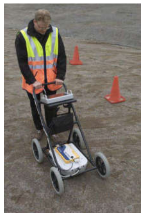
Figure 4.17 Radar RAMAC monté sur le chariot RAMAC GPR SCART [23]
