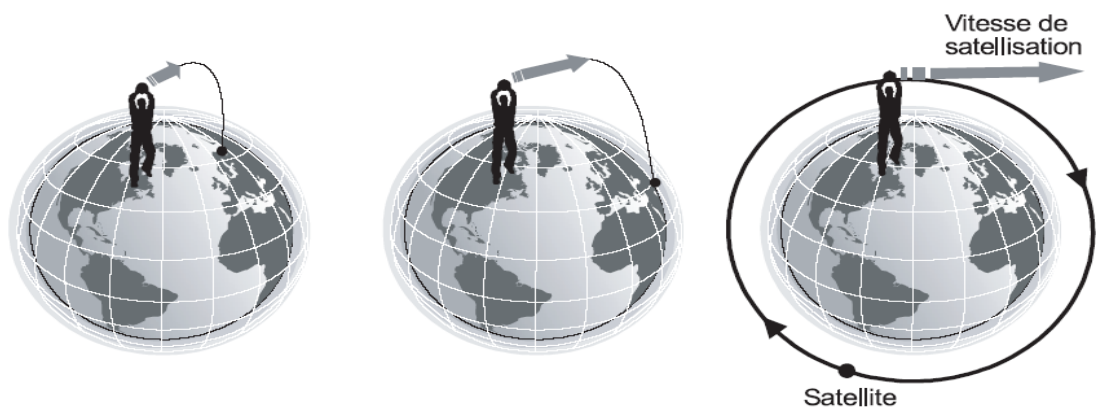
Figure.I.1. Principe de mise en orbite d'un satellite autour de la terre
