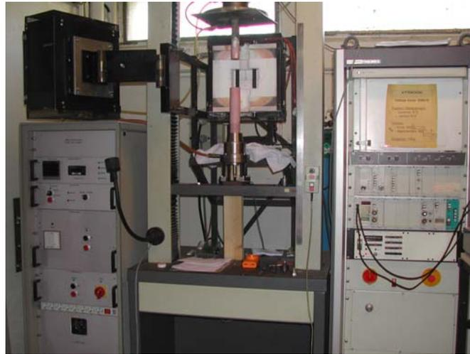
**Figure 3.8 : Machine d'essais mécanique de type Schenck-Trebell**
