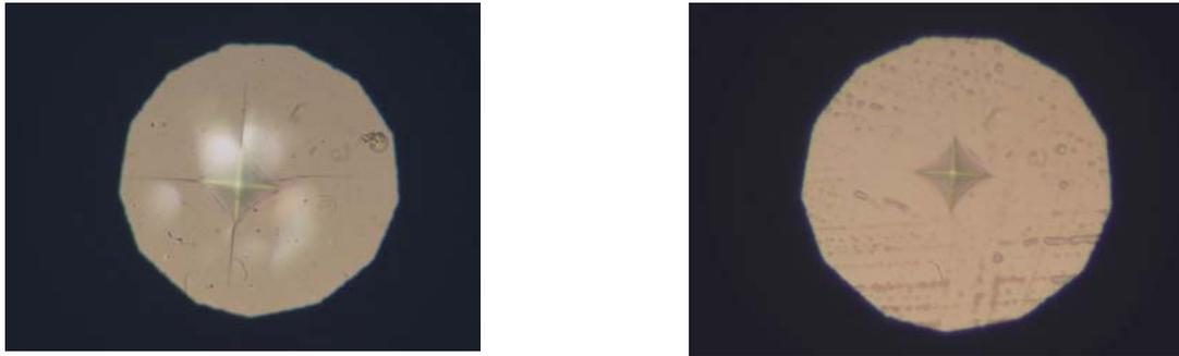
**Figure 7 .6: Empreintes Vickers et fissures radiales (P =3 N) des deux verres:
