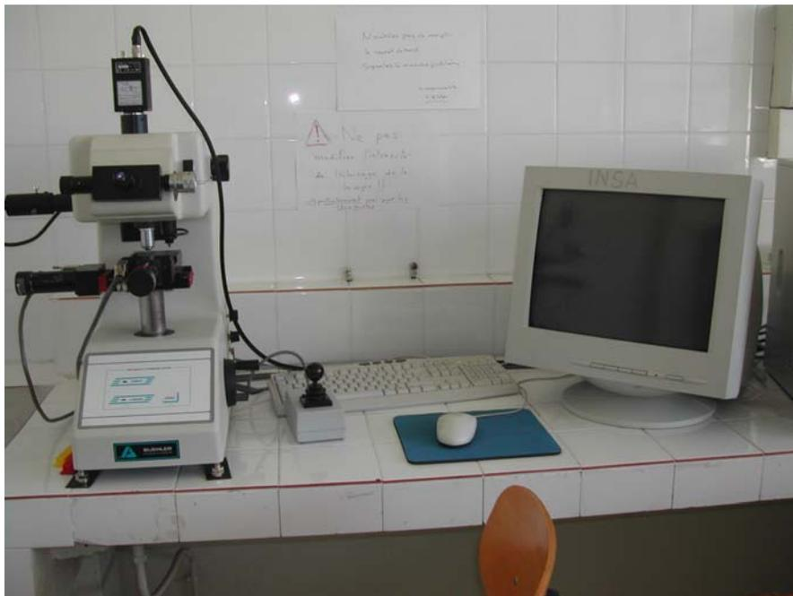
**Figure 3.10: Microduromètre utilisé**
