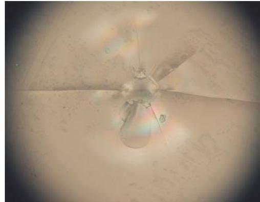
**Figure 5.10 : Fissures radiales après choc thermique (P=30N, Tc= 280°C)**
