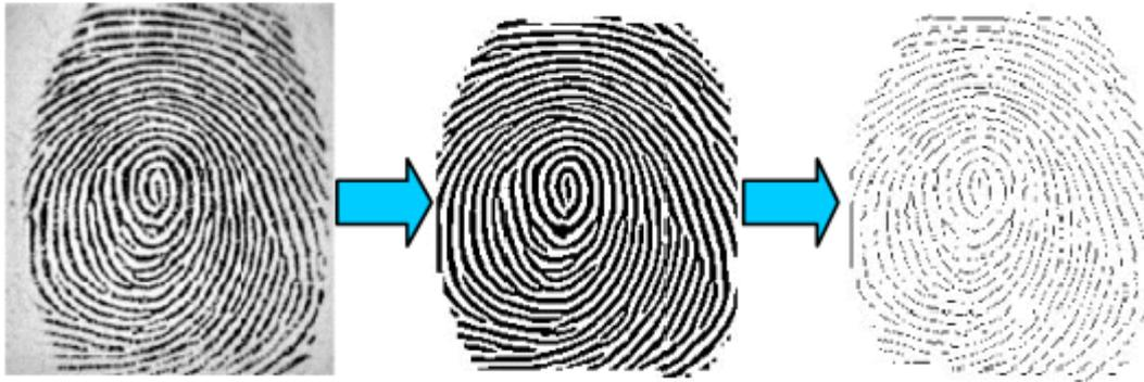
**Fig. 1.4 Pré-traitement des images d'empreintes digitales (extraction des minuties)**
