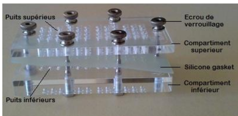
Figure 12: Photographie de la chambre de chimiotactisme (48-micro well chemotaxis chamber). La chambre est composée de deux compartiments inférieur et supérieur superposables, séparés par le silicone gasket.
