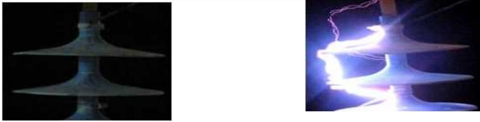
a) *Cas propre*
