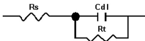
**Figure IV.4.** Circuit équivalent utilisé pour adapter les spectres d'impédance.
