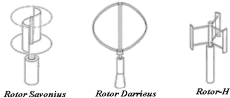
Figure 1.1. Technologies d'éoliennes à axe vertical.
