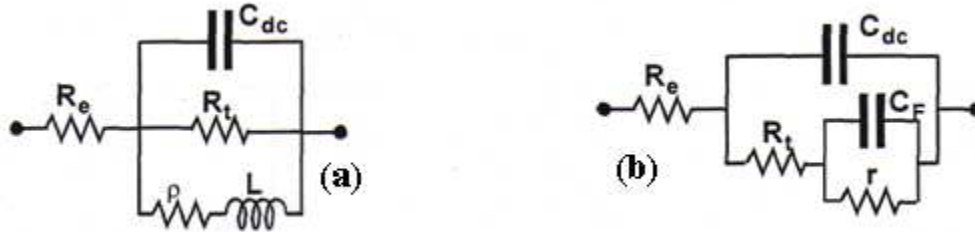
Figure II.8 : Schéma électrique équivalent de l'impédance due à la relaxation d'une espèce adsorbée, (a) Z_F inductive et (b) Z_F capacitive.
