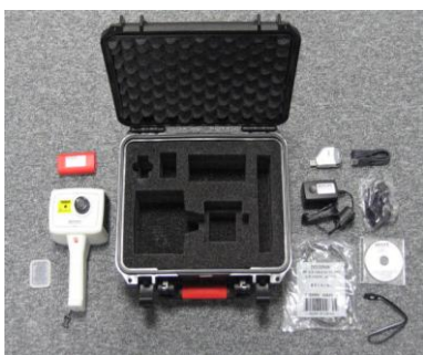
Fig.3. 5 : (a) –Camera IR : Type IRI 4010 Multi-Purpose Thermal Imager et les accessoires, (b)- Affichage et interface par le logiciel IRISYS 4000 Séries Imager
