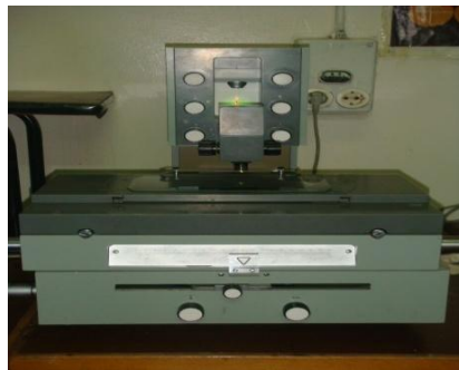
Fig .3.3- Microdensitomètre optique pour la mesure de transmission
