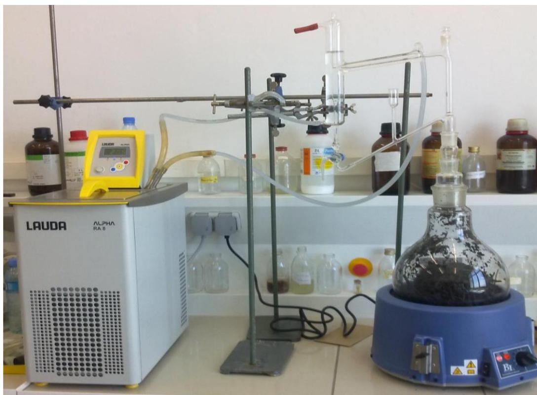
**Figure 9: Dispositif d'extraction de type Clevenger**
