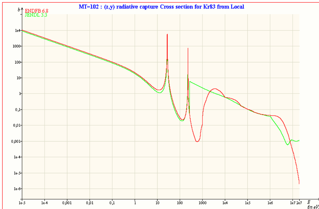
Figure (A.1) : Comparaison de la section efficace de capture ( n, \gamma ) pour le ^{83}_{36}\text{Kr} , entre les bibliothèques ENDF-B VI et JENDL 3.3.
