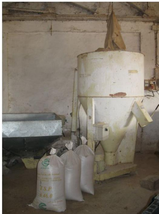
FIGURE VI.4 – Broyeur- mélangeur.
