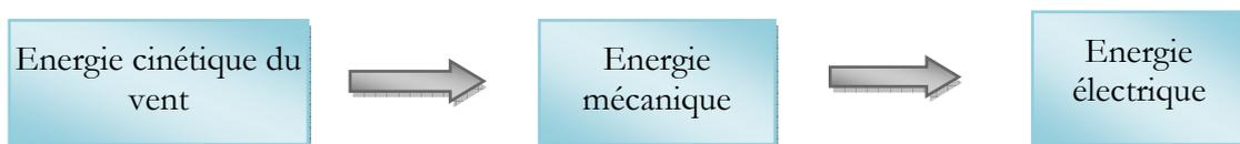
Figure 1.2. Principe de conversion de l'énergie dans une éolienne [6]
