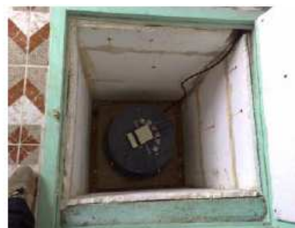
Figure III.7 : Sismomètre large bande
