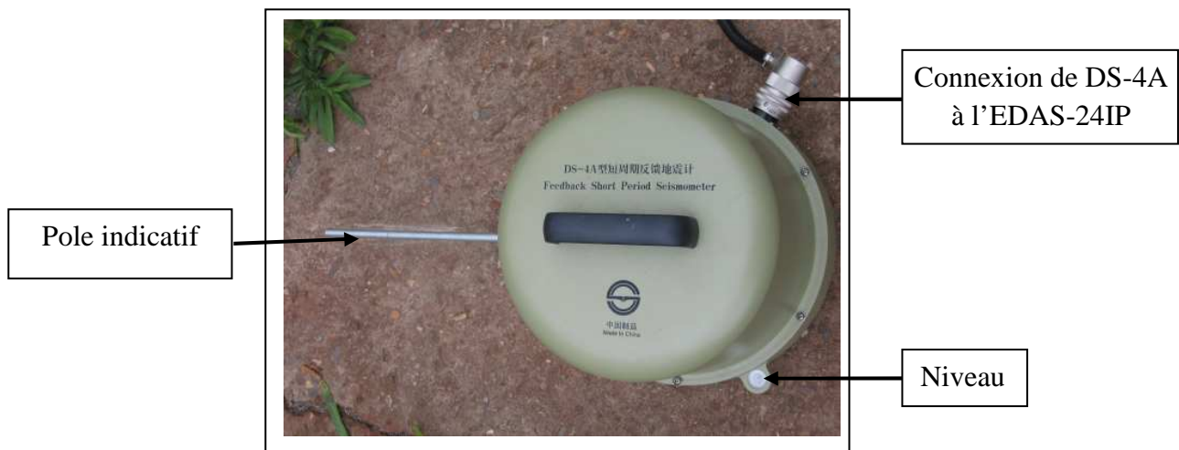
Figure V.3 : Sismomètre DS-4A courte période.
