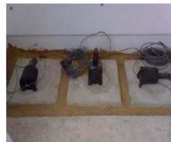
Figure III.4 : Les trois composantes de sismomètre de la station CASM.
