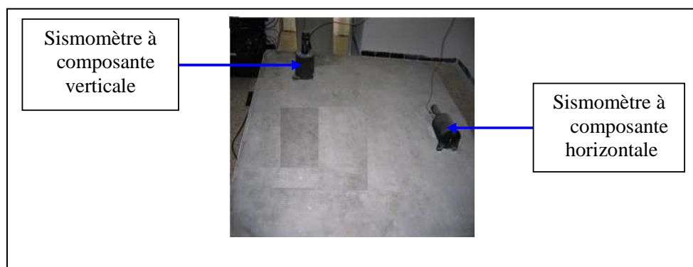
Figure V.6 : Sismomètres Kinémétrics de type SS1 courte période.
