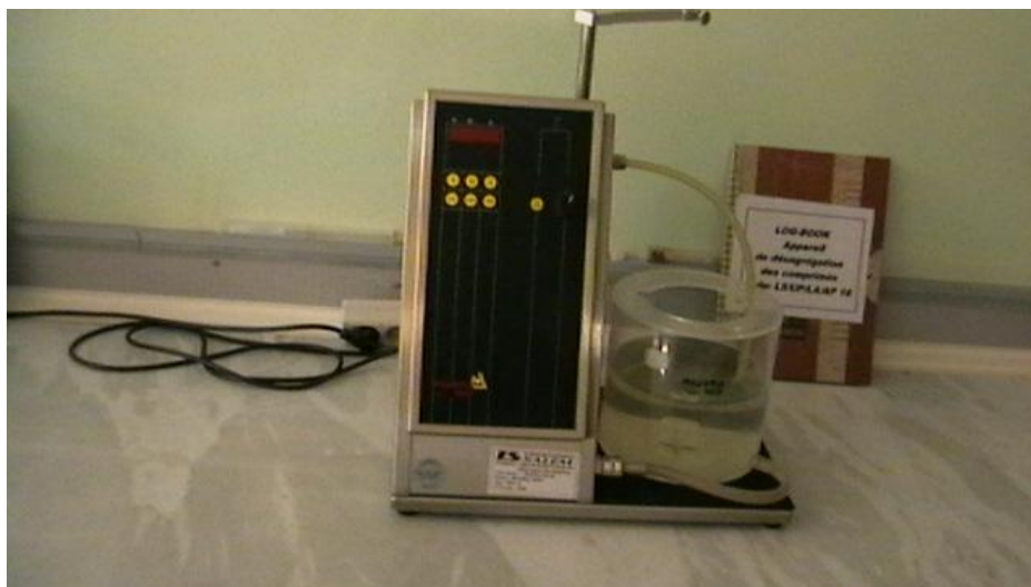
Fig V.12: Appareil de mesure du temps de désagréation
