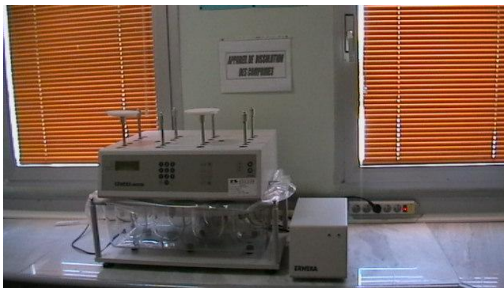
Fig V.13 : Appareil de dissolution des comprimés et des gélules (dissolutest)
