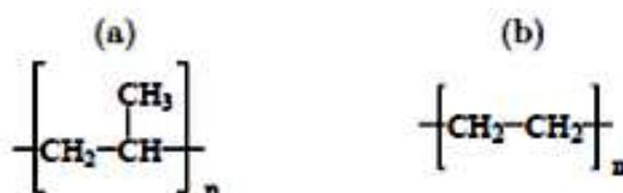
*Figure 1.8*: Structure chimique (a) du polypropylène et (b) du polyéthylène [Col01]
